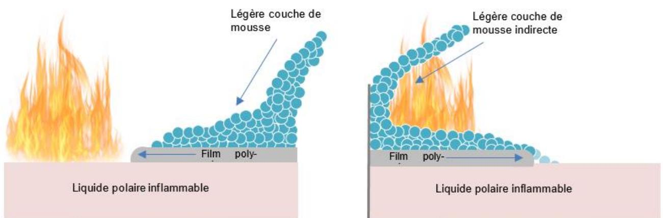
En plus de former de la mousse, les agents moussants AFFF forment également une fine pellicule aqueuse de tensioactifs qui peut se répandre rapidement sur les liquides combustibles apolaires (non miscibles à l'eau).
