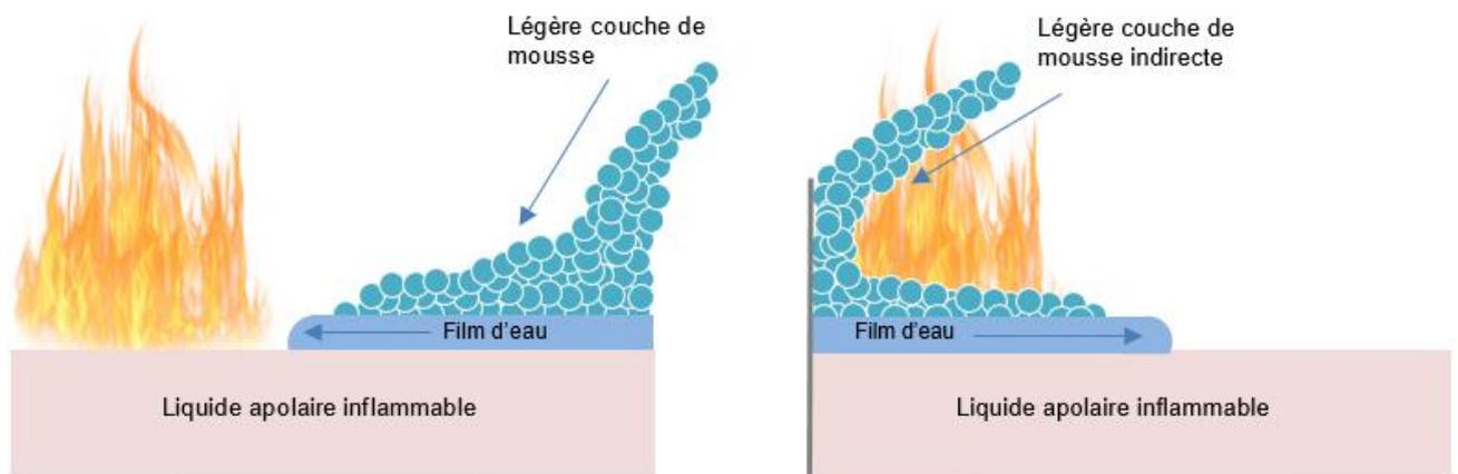
Les AFFF existent également sous une forme stable en présence d'alcool. sous forme de variante stable à l'alcool (AFFF-AR). Selon la propriété du matériau combustible (polaire ou apolaire), ceux-ci forment un film de polymère ou d'eau.
